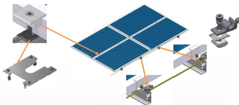
Abaixo a demonstração da fácil instalação do sistema de aterramento:
